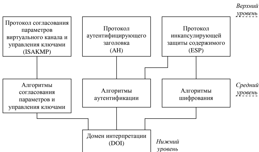
Рисунок 7.1 — Архитектура средств безопасности IPSec
